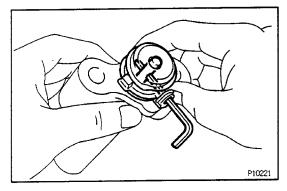
(d) Install the dust boot to the tensioner.
