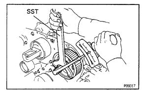
(d) Using SST, install the pulley bolt.
