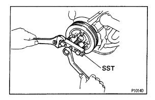
(d) Using SST, remove the pulley. SST 09213–31021
